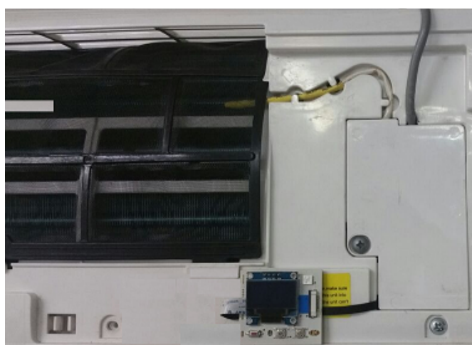
4. Tištěný spoj s displejem upevněte na šasi pod čelním panelem
