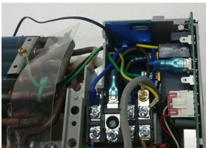
3. Provedte usazení tištěného spoje připojeného k základní desce
